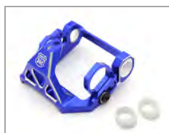
MM ワンピースアルミモ ーターマウント(MR-03用) No.R246-1355 ¥4,620(税込) R246-1201の改良版で、ヒートシン クを省略し、空間を増やしてモーター に直接風を当てクールダウンする構造 に変更、ダンパーの固定をしっかり支 えるダンパーステーは本体と一体構造 (ワンピース構造)に変更し、ダンパー の固定がしっかりとホールド可能に。
