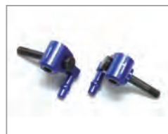
ステアリングブロック (MR-03用 キャンバー1度) No.R246-1311B ¥1,870(税込) 耐久性に優れたアルミ製ナックル。 対地キャンバー角1°
