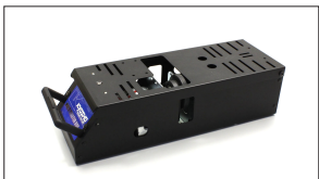
マルチスターターボックス2.0 (ブラック) No.36209 (レッド) No.36209R 各 ¥7,800 (税抜) ハイトルク550クラスモーターを2基装備。静音性 に優れたベルトドライブを採用。サイドワインダー モデル、センターシャフトモデルの両方に対応。
