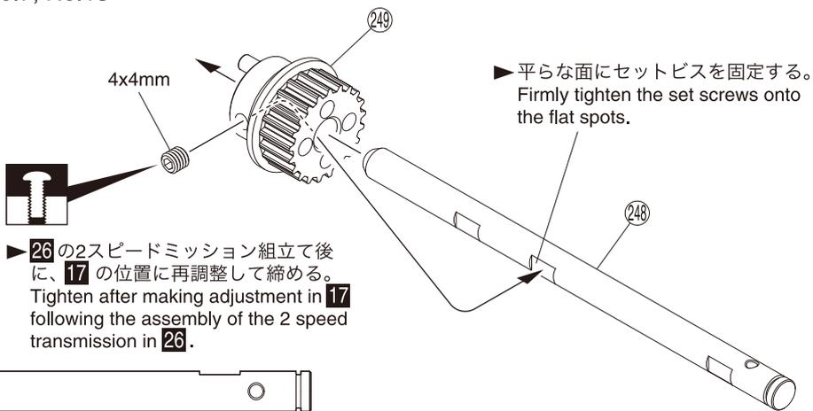
▶ 26 の2スピードミッション組立て後に、17 の位置に再調整して締める。
