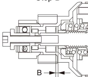
▶ Aの後、一旦3mmキャップビスを外し、クラッチベルを外し、Bのすきまがなくなりクラッチベルのガタがなくなるまで(146) 5x0.5mmシムと(147) 5x0.1mmシムをBに入れる。
