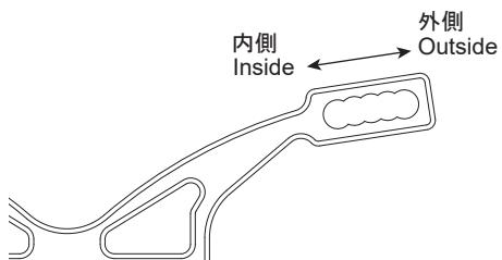
► 本製品はダンパー長（ボール-ボール）を54mmに合わせた場合、ダンパーの取り付け位置を変更してもリバウンド量が変化しないように設計されています。
