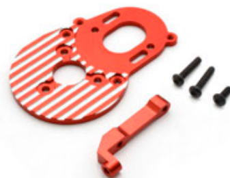
No.FAW308 SPモーターマウントプレート(FZD2) SP Motor Mount Plate (FZD2) モータープレートにフライス加工でスリットを設け冷却効率をアップ。 別売の30mmクーリングファンを取り付ける専用ステーも付属。 さらにモーターの冷却性能を向上。 Slits are milled into the motor plate to improve cooling efficiency. A dedicated stay for mounting a 30 mm cooling fan (sold separately) is also included. Further improved motor cooling performance.
