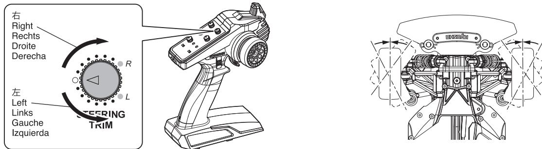
▶ ステアリングホイールに指を触れない(ニュートラル)ときタイヤがまっすぐになるようにステアリングトリムで微調整します。
