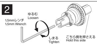
▶ボールデフは工場出荷時にほぼ適正な位置に調整されています。ボールデフの調整は 1.5mmのレンチを使いデフハウジングの中に見える2x12mmのCAPスクリューを回すことに よって行います。走行させてデフがスリップする場合にはCAPビスを約30°しめ込んで 下さい。CAPビスを絞め込み過ぎると、ボールデフが破損する場合があります。
