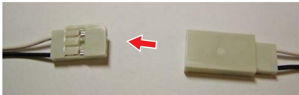
3. I.C.S ケーブルを車体の I.C.S コネクターに接続する。
