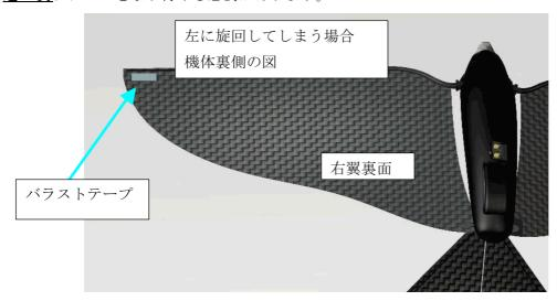
もし、左方向に旋回してしまう場合は、右の翼の裏側にバラストを貼り付けて下さい。付属のアルミテープー枚を翼の端の裏側に写真の様に貼り付けて下さい。もし、右方向に旋回してしまう場合は、左翼裏側に同じようにバラストを貼り付けて下さい。
