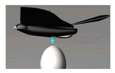
鳥を充電するには鳥下側にある端子を卵上部に接触させて下さい。端子は磁石になっており、自動的に向きが決まり固定出来ます。
