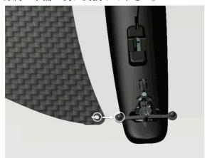
尾翼を一番高い位置(低速)に上げ、翼後部の取り付けクリップからはずして下さい。
