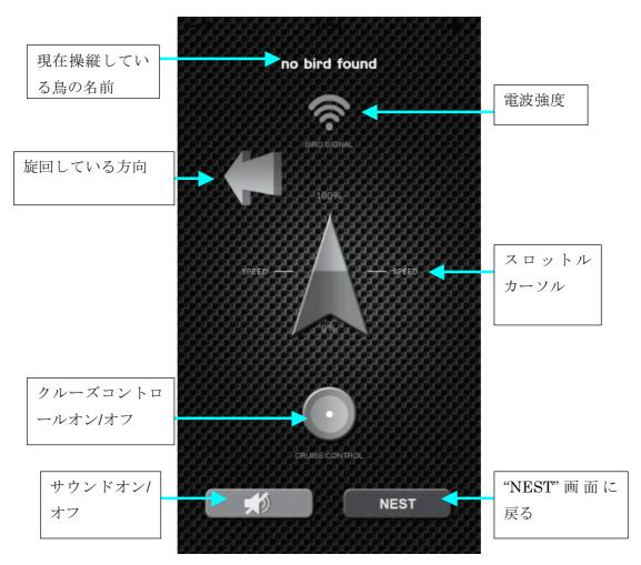
**イージーモード**:このモードでは、片手でスマートフォンを持ち、親指でスロットルカーソルを操作し、スマートフォンを左右に傾けることで鳥を旋回させます。
