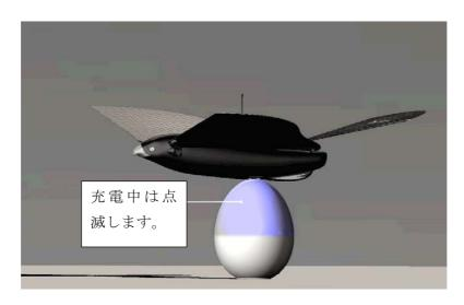
卵の上部が点滅を始めると充電開始です。約12分で充電が完了します。充電が完了すると 卵の点滅がとまり点灯し続けます。
