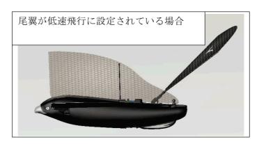
屋内で飛行する場合は低速側に尾翼を設定して下さい(下から 3 段目以上)。初心者の場合 4 段目か 5 段目を推奨します。
