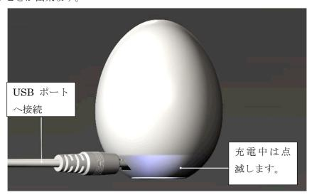
卵を充電するには、写真のようにUSBケーブルを装着し充電して下さい。充電中は卵下部が点滅し、約90分で充電が完了します。鳥を充電するには卵を完全に充電する必要はありませんが、飛行時間を最大限得る為に完全に充電して使用することを推奨します。 充電完了後5分に自動的に電源がオフになります。
