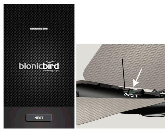
**鳥の検出**:<u>必ずアプリを先に起動してください、</u>"Searching bird"と表示されます。その後すぐにバイオニックバードの電源をオンにして下さい。鳥が検出されます。
