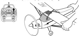
► スロットルスティックを一番下まで下げてプロペラが止まるか確認。 Move Throttle Stick all the way down to confirm propeller stops
