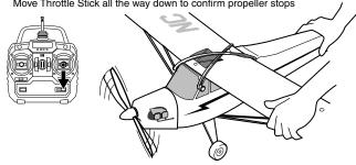
▶ プロベラの回転が止まらない場合はスロットルトリムで調整する。 If propeller doesn't stop completely, adjust Throttle Trim accordingly
