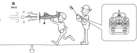
▶ 手投げ後、左右に傾かないようにラダーを操作して調整。フルスロットルのままで10~20° ぐらいの角度で上昇する。 上昇しなかったりする場合はエレベーターを操作して調整。40mぐらいの高度に達したら旋回開始。(バッテリーの充電が不十分だと上昇しない) After launching, use the rudder to stop plane from tilting left or right. If using an amp, climb 10~20° at full throttle. If plane doesn't climb accordingly, adjust with elevator control. After reaching an altitude of about 40m, beginning circling the plane. (If battery is not charged properly, plane will not ascend).
