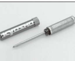
ストレートリマー(3.05mm) No.YKW001 ¥2,940(税込) サスアームのシャフト穴をベストサイズで滑らかな仕上がりにする専用リマー。サス作動の円滑化と安定化を約束。
