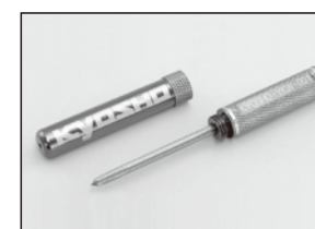
ストレートリーマー(3.05mm) No.YKKW001 ¥2,940(税込) サスアームのシャフト穴をベストサイズで滑らかな仕上がりにする専用リーマー。サス作動の円滑化と安定化を約束。
