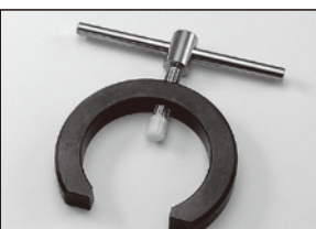
フライホイールブローラー No.80162 ¥2,625(税込) フライホイールとコレットの噛み込みを、フライホイールを傷つけることなく、簡単に外すことが可能な便利ツール。
