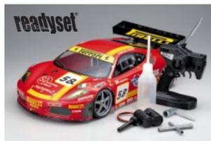
世界チャンピオンマシン“インファerno”MP-7.5”を母体としたGTカーシャーシ。 リコイルスターター付GXR28エンジン搭載済み。 2速A/Tを標準装備。 熟成のシャフトドライブ3デフのフルタイム4WD。 サーボリンクケジもすべて完了し、ボディも塗装済みレディセット。 カラーリングもカットもデカル貼りも完了の完全完成ボディが付属。 豊富なインファerno用オプションパーツが使用可能。
