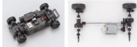
理想の走りを形にしたミッドシップモーターマウントに前後デフを組み合わせたシャフトドライブAWDシャシーを新開発。優れた路面追従性を実現するキングピンストラット方式の4輪独立サスペンション採用。
