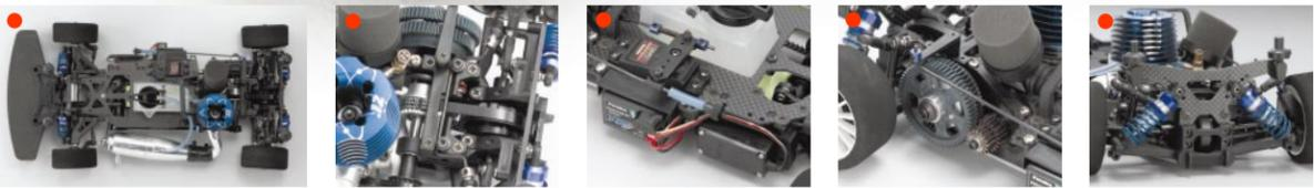
2004年IFMAR 1/10GPツリングカー世界選手権を制したシャーシをさらに熟成。関連構造を見直し、単純な手順でメインシャフトの脱着を可能にするなど、実戦向けのメンテナンス性をさらに向上。リアバルクヘッド上側のパーツ形状を変更し、アッパームピボットの選択が従来の2カ所から5カ所まで可能に、よりキャンバー変化率を減らしたセッティングも可能。新レイアウトのメカプレートを採用。縦置きスロットルサーボレイアウトとしてメンテナンス性を向上。また肉抜き形状や角度に左右舵角のゲージの役目を持たせるなど、実戦で役立つアイデアを盛り込んだ設計を徹底。ギヤやメインシャフトの素材等を見直し、駆動系の耐久性を大幅向上。新レーターの内径13ダンパースプリングを採用してセッティング自由度を向上。両面研磨仕上げのブレーキローター、テフロンブレーキパッドの採用で抜群の制動力と最高のブレーキングフィールを約束。またアルミブレーキハブに加え、ブレーキローターとプリーの構成を変更し、レースの序盤からゴールまで今まで以上に変わらぬ制動力維持を実現。
