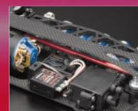
付属の樹脂製トレイを前後反転する事で、バッテリー位置を4mm変更する事が可能。微妙な重心セットが、最高のパフォーマンスを発揮。
