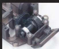
前後合計4個のボールベアリングでデフユニットを支持。フロント4本、リア6本のピスでユニットごと脱着可能。
