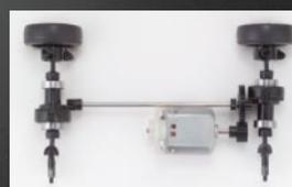
ミッドシップモーターマウントによる絶妙な重量配分に加え、1次減速からセンタードライブシャフト、前後デフギヤの精密加工により、理想的なAWDシャシーを実現。
