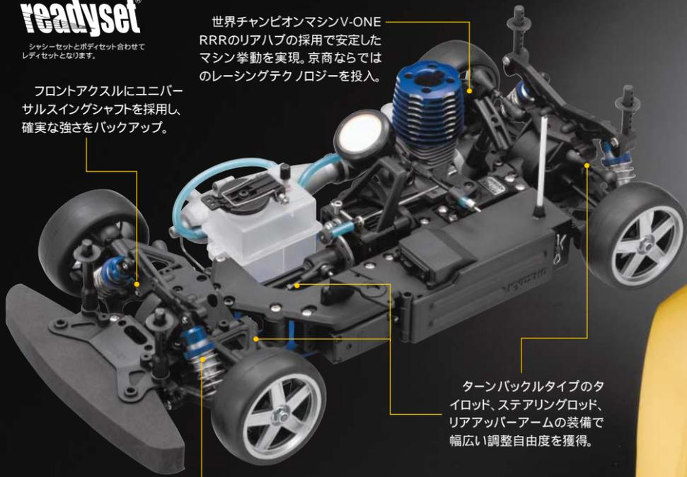
ターンバックルタイプのタイロッド、ステアリングロッド、リアアッパーアームの装備で幅広い調整自由度を獲得。
