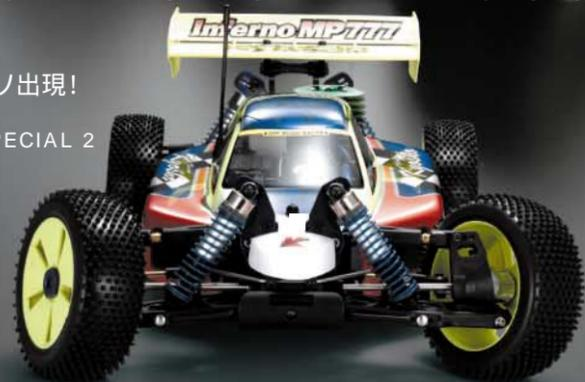
樹脂製のメインシャシーとXバックボーンアッパーデッキとの組合せにより、前後左右で高い剛性を発揮するシャシーがサスペンション性能を存分に引き出した走りを実現。
