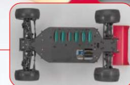
パラレル搭載、バックバッテリー搭載の両方に対応するシャシーレイアウト。
