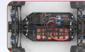
調整自由度の高いターンバックル式アッパーアームのダブルウィッシュボーンサスペンション。
