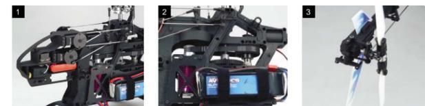
高精度樹脂製モノコックフレームで3Dフライトにも万全の強度と剛性。余裕のワンウェイユニットでハイパワーモーターに対応。ラダーも含めて全舵両引きリンケージにより逃げのない操縦感を実現。
