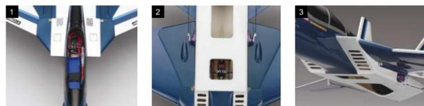
難しい加工不要で完成し、キャノピーの脱着だけでバッテリー交換が可能。サーボ1個で後退角を可変するシンプルな構造。飛行中も自在に制御可能。機体後部に小型軽量のDF45ダクトファンユニットを内蔵。ブラシレスモーター&ファン一体式の高効率ユニットで約270gファン単体推力の大きな推力。
