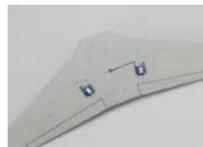
エルロン用2個、エレベーター用1個のマイクロサーボを搭載済み。25Aブラシレスモーターコントロール専用アンプも付属。
