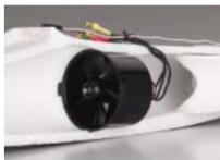
5翅ファン式55mm外径のDF55ユニット。付属の高性能ブラシレスモーターにより、大推力を安定して発生。
