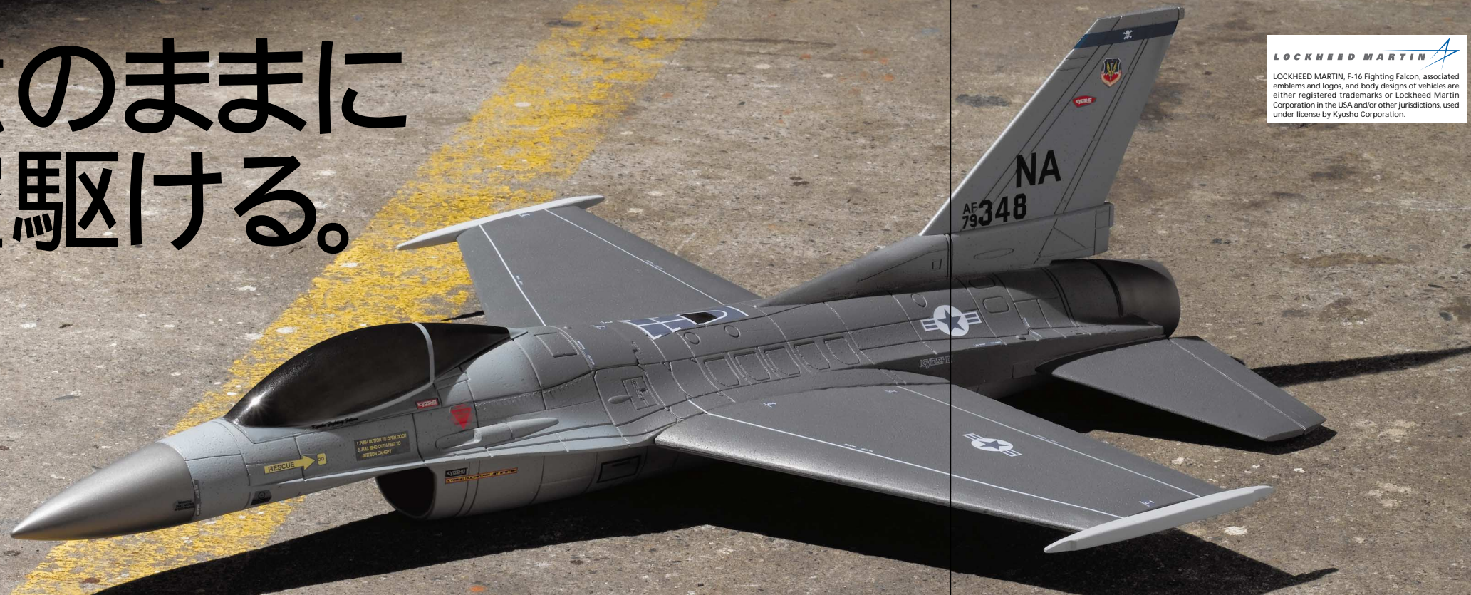
5翅ファン採用の外径 55mmのコンパクトな電動ダクトファンユニットを装着済み。 キャノピーの脱着のみでバッテリールームへアクセス可能。交換や装着も面倒な手順なく短時間で可能。 付属のサーボ2個を送信機側でミキシングし、水平尾翼後縁のエレポン1対でロール軸とピッチ軸を制御。
