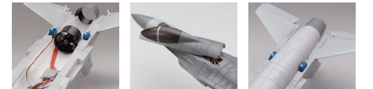
5翅ファン採用の外径 55mmのコンパクトな電動ダクトファンユニットを装着済み。 キャノピーの脱着のみでバッテリールームへアクセス可能。交換や装着も面倒な手順なく短時間で可能。 付属のサーボ2個を送信機側でミキシングし、水平尾翼後縁のエレポン1対でロール軸とピッチ軸を制御。
