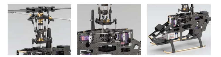
アルミ製のセンターハブ、そして京商独自のEMS(120スワッシュモード)で、ダイレクト感あふれる操縦性を獲得。 全舵両引きリンクで逃げのない操縦感を実現。さらに主要3舵のレバーを同軸配置とし、均質な操縦性とセッティング容易度を実現。 高剛性で軽量な1mm厚カーボン製ボックス構造メインフレームを新開発。ギヤ軸を集約し、駆動ロスの軽減と軸間距離調整が容易に。
