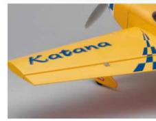
エルロンは左右独立サーボ搭載式でリンクージも簡単。絶妙な面積設定で、KATANAならではのアクロ性能を披露。
