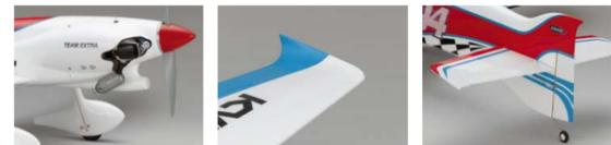
精密でリアルなフォルムの基本カラーリング済みFRP製胴体、カウルのリアルさは圧倒的。徹底してリアルさを追求。脚部からタイヤまで覆い、整流効果を高める巨大なホイールバンツもカラーリング済みFRP製で再現。実機通りのウイングレットを一体化した翼端。揚抗比を高効率化して翼端失速を抑え、低速時の安定性も向上。バルサ製フィルム張り済み主・尾翼。機体の主要部は工場完成。主翼の接合と尾翼の取り付け、サーボリンクージで完成。上下面積を平均化した独特な形状の垂直尾翼はFRP製で胴体と一体成型。尾輪運動でタキシングも自在。空気抵抗を極力減少させるために、エルロンサーボは埋め込み式。キット状態で構造的なスペースを確保。
