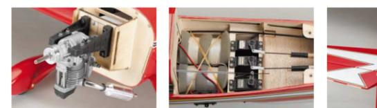
軽量なバルサ製構造にフィルムによるカラーリングを施した工場完成キット。 模型化に合わせて最適化した各部スベックにより、実機通りのアクロ性能を実現。 翼型断面を盛り込んだ水平・垂直尾翼により、スムーズな姿勢制御とリアルなスケール感を約束(50) 剛性感あふれる主・尾翼、胴体により、優れた耐久性と操縦特性を実現。(50) ストリンガー構造の後部胴体と、肉抜きを施した尾翼・動翼、前縁部ブランクを最少に抑えた主翼等により、理想的な軽量化を達成。(EP) エレベーター、ラダーサーボを尾翼直前に装備し、リアリティに富んだ操縦感覚を実現。(EP) メンテナンスや調整の楽なラダー貫通左右一体式エレベーター。(EP) 塗装済みのFRP製カウル、ホイールバルブ、ハードアルミ製左右一体メインギヤを付属。 リンケージパーツも付属。プロポとパワーソース、始動用具関連以外の必要物が付属した充実のキット。 ラダー連動可動式テールギヤで、確実かつ安全なタキシングが可能。
