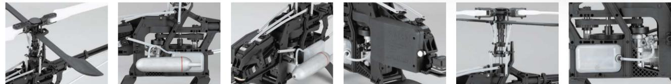
まったく新しい樹脂製上下シェル構造の対称翼のメインローターを付属。前縁部に配置したブラストで素直な操縦性と安定性を実現。スタビバー、スタビブレード、ヒラートコントロールレバーがワンユニットとなり、調整不要でベストセットが可能。OSMAX32SX-H RINGエンジンが付属。ベルト駆動2段減速ミッションと組み合わせて、静かなのに力強い飛行を実現。プロポの機能に頼らない革新的なサーボマウント駆動機構のメカニカルミキシングシステム(MMS)。受信機&バッテリーを搭載後のリード線処理が容易なメカボックス。軽量で丈夫なスキッド一体型軽量ブレース。メインフレームは半完成。組み立てに必要な時間を大幅短縮化。
