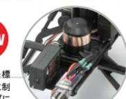
サイクロン社製ブラシレスモーターを標準付属。パワフルに、そしてスムーズに制御するスカイビクトリー-BLS35アンプによって、安定したフライト性能を実現。
