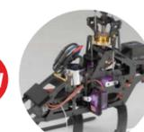
メタルスワッシュプレート、アルミ削り出しセンターハブ、6mmジュラルミン製メインマスト、金属製ピッチスライドリングなど、高剛性パーツ標準装備。
