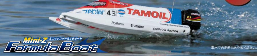
強力モーターとフレキシブルジョイントで安定した加速と高速度性能、旋回性能を獲得。受信機、スピードコントロールアンブ、サーボアンブを一体化させ、耐水コーティングしたユニットで安心。独自の船外ユニット内にラダーサーボを内蔵。推力線をダイレクトにステアリング。スラストラインを-10から0の範囲で可変可能。細かな走航調整が可能。FM方式BETバンドのプロボを搭載済み。複数台同時走航を約束。6Vニッケル水素バッテリーを充電器コネクタに接続し、チャージングボタンを3分押しせば5分の走航が可能。
