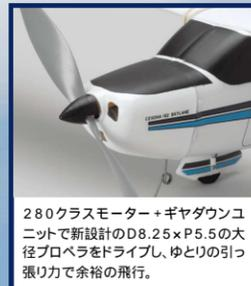
280クラスモーター+ギヤダウンユニットで新設計のD8.25xP5.5の大径プロペラをドライブし、ゆとりの引張り力で余裕の飛行。
