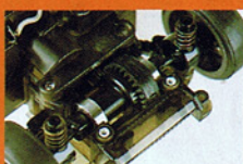
3ベベル仕様のデフギヤユニット。その精密な作りは絶句
