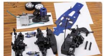
痛みきったシャシーを解体したところ。ブルーの板がアルミ製のメインシャシー。これが歪んでいた。
