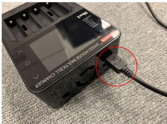
USB ケーブルの反対側を PC の USB ポートへ差し込んで下さい。
