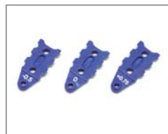
H プレートホルダー (MR-03用 -0.5/0/0.75mm) No.R246-1321 ¥1,620(税込) 3種類のプレートホルダーを使い分けることで、モーターケースの取り付け高さの調整が可能。
