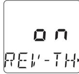
「SEL」キーを押し REV 設定画面を呼び出し、「CH」キーを押し「REV-TH」の表示にし、その際「ON」になっていればリバースに設定されています。Press the SEL key to display the REV setting screen, then press the CH key to display 'REV-TH'. On indicates reverse setting has been selected.
