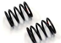
VZW414-32516 500 フロントスプリング (3.25-1.6/レッド/L=21.5/φ1.3/2pcs) Front Spring (3.25-1.6/Red/L=21.5/φ1.3/2pcs)
