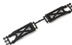
UM713B *700 リヤサスアームセット Rear Sus. Arm Set
