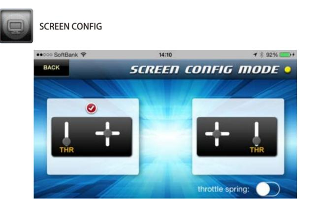
スロットルを左側のカーソルで操作するのか、右側のカーソルで操作するのかを選択することができます。また、「6CH」モードの場合には[throttle spring]をONにすることで、カーソルから指を離した際に、カーソルが自動的にニュートラル(中立)戻るように設定を変更することができます。(通常飛行機やヘリコプターを操縦する場合にはチェックを外します。) Choose whether throttle is to be controlled by moving the right or left cursor. Also, in 6ch mode the throttle spring slide button can be “ON” so the cursor returns to neutral when your finger is released. (Normal setting for airplanes and helicopters is “OFF”).
