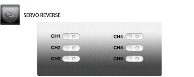
各チャンネルを操作して、サーボの回転方向、モーターの回転方向が反対の場合に使用します。該当するチャンネルをタップして回転方向を反転させてください。
