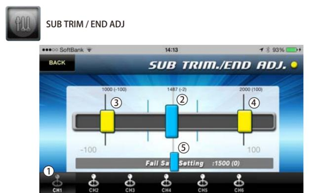
各チャンネルのサーボのニュートラル(中立)、動作範囲、フェイルセーフの動作位置(ポイント)を設定できます。各位置を調整する際に、実際にサーボがその位置へ移動します。調整を開始する前に必ず車体を台の上に載せ、タイヤを床から浮かして下さい。またプロペラが装着されているモデルは必ずプロペラを取り外して下さい。
