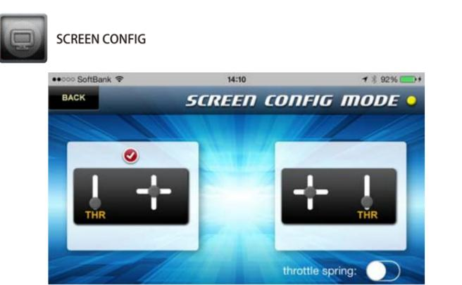
スロットルを左側のカーソルで操作するのか、右側のカーソルで操作するのかを選択することができます。また、「6CH」モードの場合には[throttle spring]をONにすることで、カーソルから指を離れた際に、カーソルが自動的にニュートラル(中立)戻るように設定を変更することができます。(通常飛行機やヘリコプターを操縦する場合にはチェックを外します。) Choose whether throttle is to be controlled by moving the right or left cursor. Also, in 6ch mode the throttle spring slide button can be “ON” so the cursor returns to neutral when your finger is released. (Normal setting for airplanes and helicopters is “OFF”).
