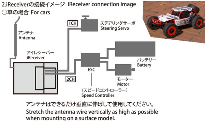
**警告** **WARNING!** iReceiverに供給される電流が十分でない場合、iReceiverが作動しない、または途中でコントロールができなくなる場合があります。
