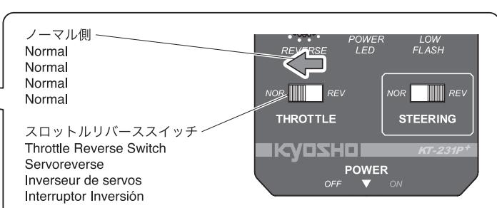
② スピードコントローラーのスイッチがOFFになっていることを確認してバッテリーのコネクターを接続します。
