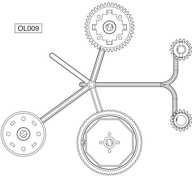
ランナー付プラパーツ配置図 (2) / Arrangement of plastic parts on runners (2)
