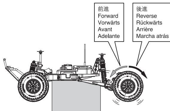
注意：スロットルを前方から後方に移動すると、スピードコントローラーはブレーキがかかります。バックを行うにはブレーキをかけて車を停止させ、ブレーキを離し再びスロットルをバック位置に動かします。車が完全に止まった時に後方走行を開始することができます。
