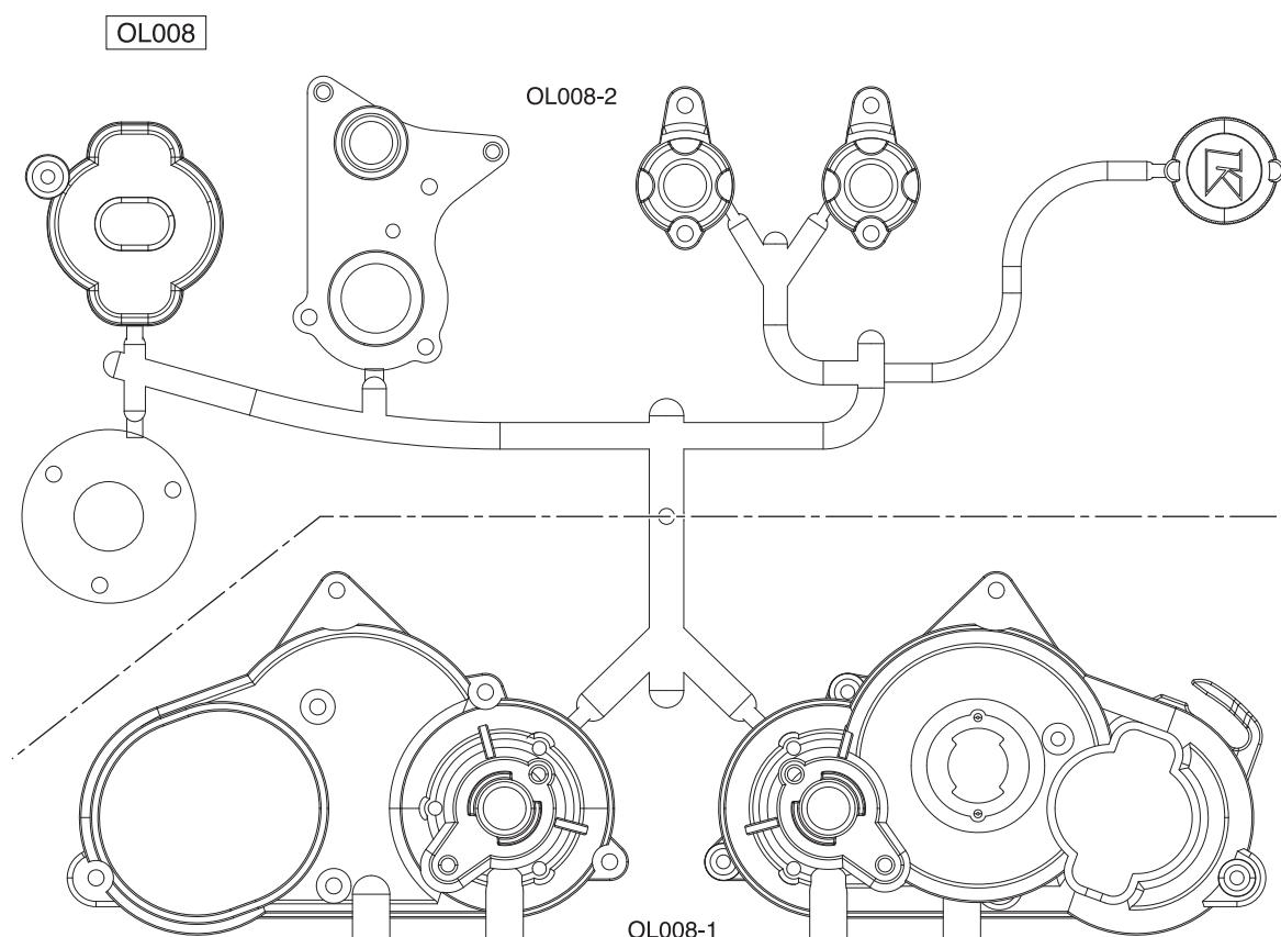
ランナー付プラスチック配置図 (3) / Arrangement of plastic parts on runners (3)
