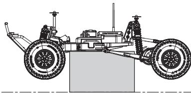
► ステアリングホイールを操作してフロントタイヤの動きをチェック。
