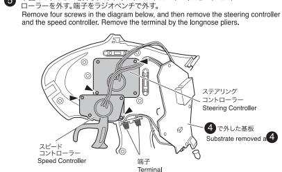
下図の4本のビスを外し、ステアリングコントローラー、スピードコント
