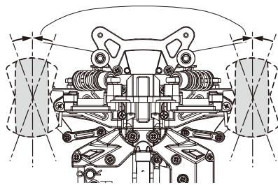
► ステアリングホイールに指を触れない(ニュートラル)ときタイヤがまっすぐになるようにステアリングトリムで微調整します。
