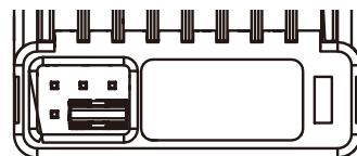
Ni-MH/Ni-cdバッテリーを使用する場合(出荷時の設定)
