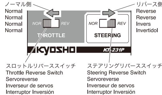
ステアリング、スロットルの動作方向を反転させる時に使用します。
