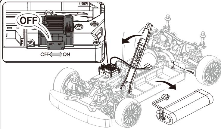
►走行後や、走行させない時は必ず電源スイッチをOFFにし、車体と送信機の電池を取り外してください。誤作動や電池の発熱・液漏れなど危険な場合があります。
