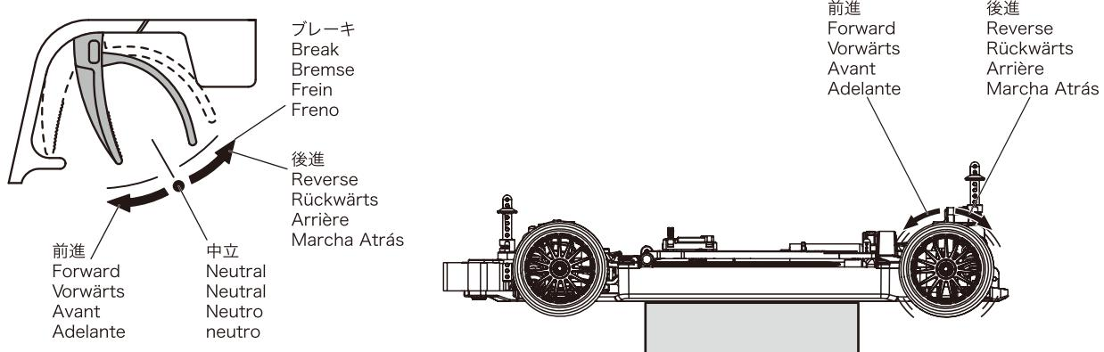
注意:スロットルを前方から後方に移動すると、スピードコントローラーはブレーキがかかります。バックを行うにはブレーキをかけて車を停止させ、ブレーキを離し再びスロットルをバック位置に動かします。車が完全に止まった時に後方走行を開始することができます。
