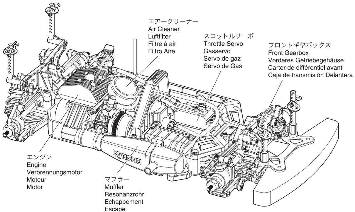
**1** エンジン各部名称と働き / ENGINE DESCRIPTION / Der Verbrennungsmotor / Description du moteur / PARTES DEL MOTOR
