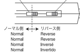
ステアリング、スロットルの動作方向を反転させる時に使用します。
