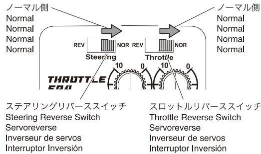
ステアリング、スロットルの動作方向を反转させる時に使用します。
