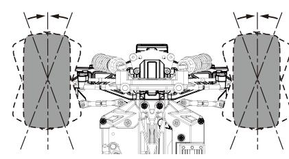
► ステアリングホイールに指を触れない(ニュートラル)ときタイヤがまっすぐになるようにステアリングトリムで微調整します。
