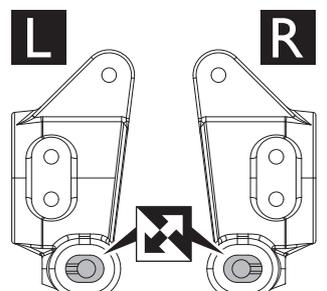
**9** リヤサスアームの交換 / Replacing Rear Sus Arm / Hinteren Querlenker austauschen
