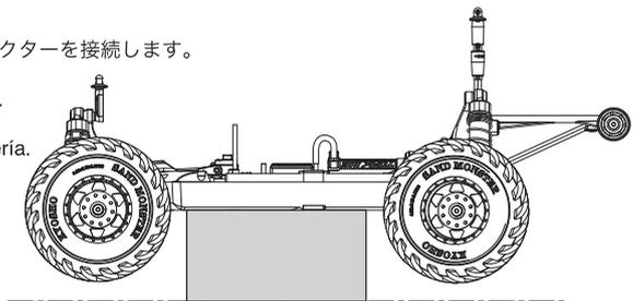
**3** 動作確認の際、タイヤが接触しないように台の上に乗せて浮かせます。
