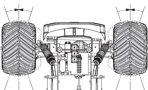
►ステアリングホイールに指を触れない(ニュートラル)ときタイヤがまっすぐにになるようにステアリングトリムで微調整します。
