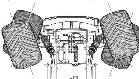
\* ステアリングホイールの操作量に応じて舵角が変わります。操作量が大きいほど、舵角も大きくなります。
