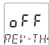
**②** スピードコントローラーのスイッチがOFFになっていることを確認してバッテリーのコネクターを接続します。
