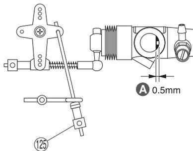
▶ **A** が0.5mm以上ある時には、トリムをブレーキ方向に回して0.5mm以下に調整する。
