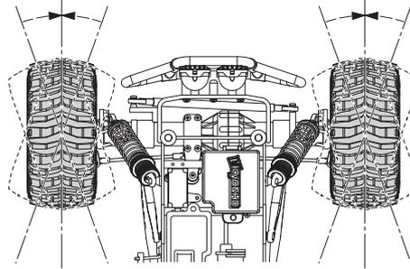
▶ シャシーのスイッチを "ON" にした時、フロントタイヤが左右に曲っている場合に調整します。
