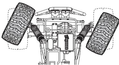
▶ ステアリングD/Rアジャスターを右側に一杯回した所から、1目盛分戻した所が最大舵角の目安となります。
