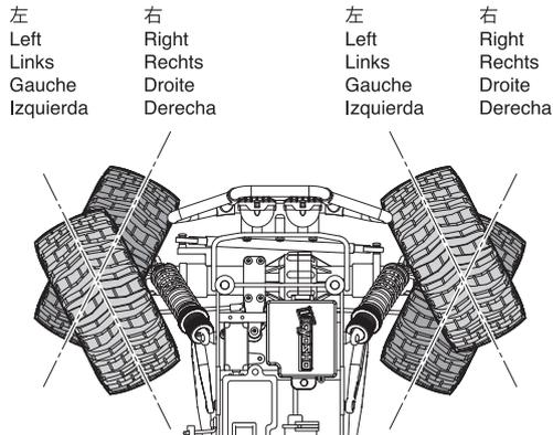
\*ステアリングホイールの操作量に応じて舵角が変わります。操作量が大きいほど、舵角も大きくなります。
