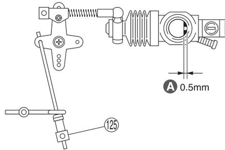
▶ **A** が0.5mm以上ある時には、トリムをブレーキ方向に回して0.5mm以下に調整する。
