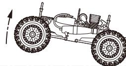
► ステアリングホイールを操作してフロントタイヤの動きをチェック。
