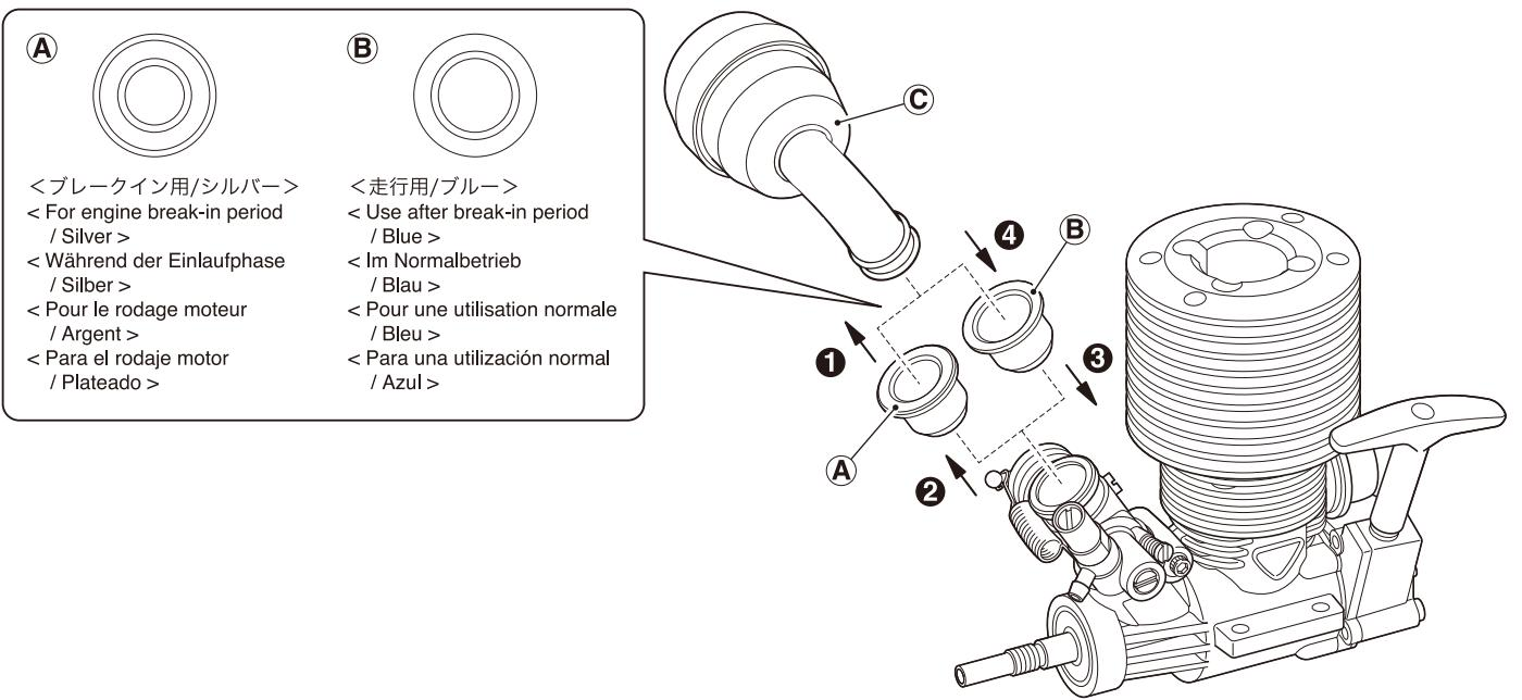
**1** この KE25 エンジンには工場出荷時に最適なブレークインを行なうため、ブレークイン用の **(A)** レデューサー(シルバー / リング)が装着されていますので、ブレークインが終了するまでこのままの状態で走行を開始してください。(キャブレターの各部はブレークインに最適な状態に調整されていますので、ブレークインが終了するまではさわらないでください。) **(C)** エアクリーナーはエンジンに必ず装着してください。
