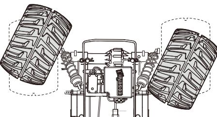
\*好みに合せて操縦しやすい位置に調整します。
