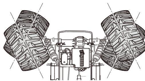
\* ステアリングホイールの操作量に応じて舵角が変わります。操作量が大きいほど、舵角も大きくなります。
