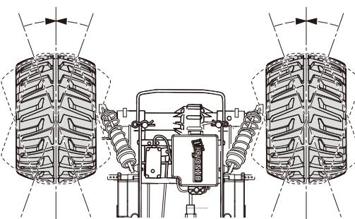
►ステアリングホイールに指を触れない(ニュートラル)ときタイヤがまっすぐになるようにステアリングトリムで微調整します。
