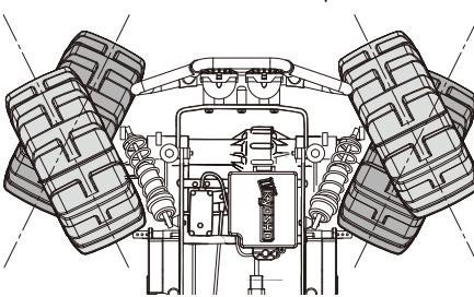
\* ステアリングホイールの操作量に応じて舵角が変わります。操作量が大きいほど、舵角も大きくなります。
