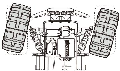
►ステアリングD/Rアジャスターを右側に一杯回した所から、1ストローク分戻した所が最大舵角の目安となります。
