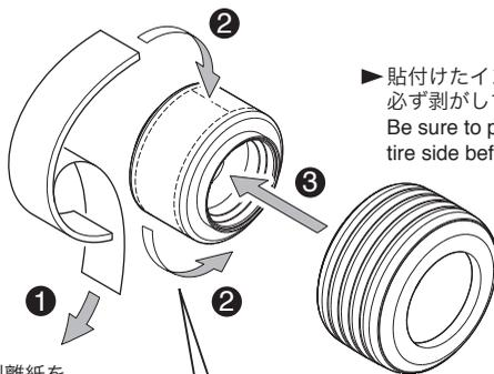
▶ 貼付けたインナーテープの外側の剥離紙を必ず剥がしてからタイヤに組込みます。
