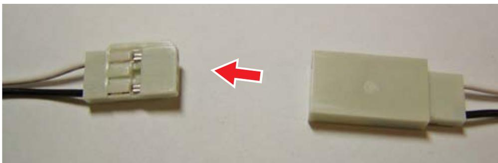
3. I.C.S ケーブルを車体 (Mini-Z もしくは dNaNo) の I.C.S コネクターに接続する。
